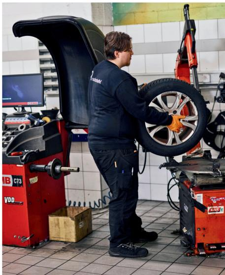
Le démonte-pneus et la machine à équilibrer les pneus sont proches l'un de l'autre. **Les distances de transport sont ainsi réduites.**
