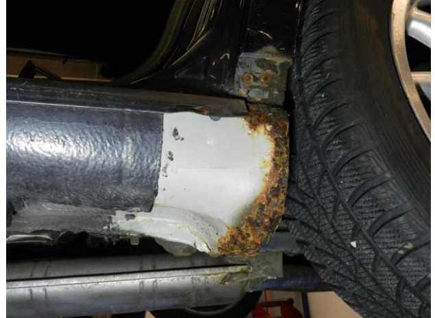
Mängel an der Schwellerecke hinten: Durchrostung
