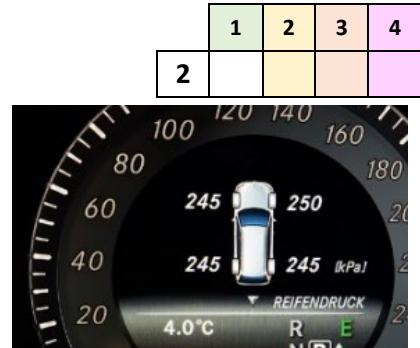
b) Geben Sie die Druckdifferenz des vorderen linken und rechten Rades in mbar an.
