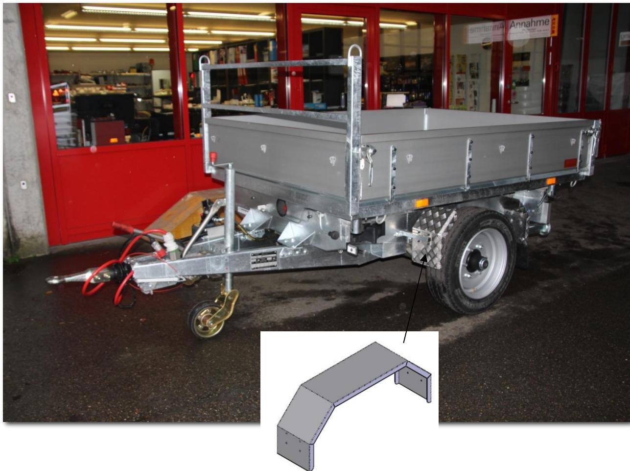
Der Auftrag für Sie beinhaltet neben kleineren Dingen auch das Herstellen einer neuen Radabdeckung, da der Kunde nicht möchte, dass die Unterseite der verzinkten Brücke übermäßig mit Schmutz verunreinigt wird.
